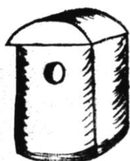
Рис. 16. Опилочно-бетонное гнездовье (5:1), отлитое в деревянной форме, Крышка отливается отдельно. Толщина стенок около 3 см
